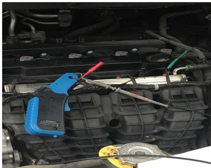
图7 电流钳的使用方式
